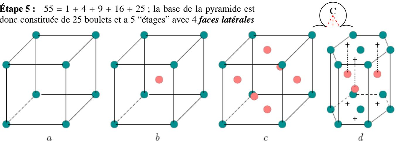
**Figure 1 :** empilements cubique simple (a), cubique centré (b), cubique à faces centrées (c), hexagonal compact (d).
