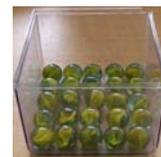
☞ Cas d'un **assemblage cubique centré** : la densité précédente peut être grandement améliorée en espaçant légèrement les sphères de façon à pouvoir insérer une sphère supplémentaire au centre de chaque cube élémentaire de telle sorte que les sphères soient tangentes selon la diagonale principale du cube dont les sommets sont les centres des 8 sphères "extérieures" comme ci-contre.
